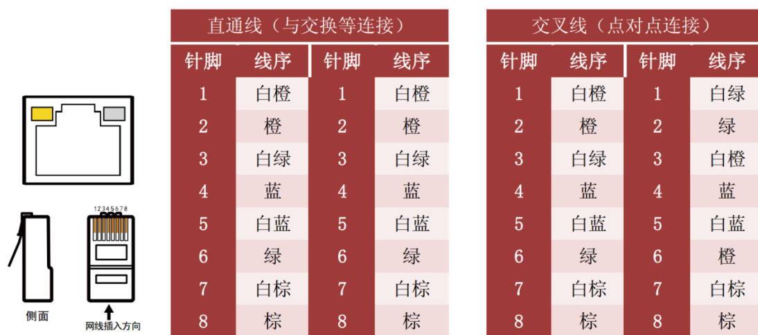
图 3-1 RJ45 接口定义及网线连接
